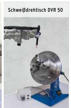
Dreibackenfutter für ein genaues Positionieren und Fixieren des Werkstücks
