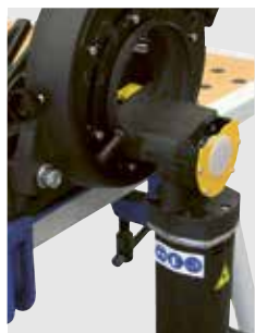
Inklusive zweite Sägeblattaufnahme zum Heraustrennen von Rohrbögen
