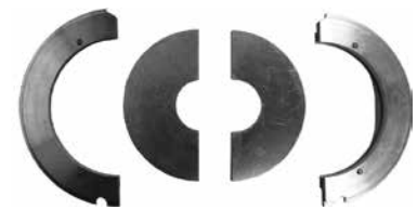
Einsatz zum Bogenschweißen (Grundaufnahme/Abdeckscheibe)
