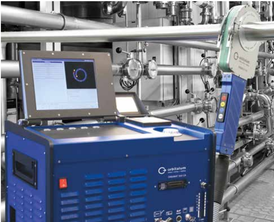
10,5"-Schwenkmonitor und Systemdrucker integriert
