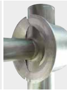
T-Stück-Spanneinsätze mit Aufnahmefähigkeit des ausgehalsten und des anzuschweißenden Rohres
