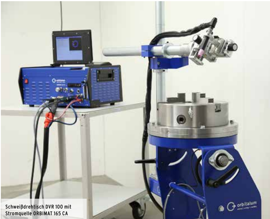
Dreibackenfutter für ein genaues Positionieren und Fixieren des Werkstücks
