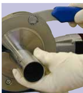
Schnellwechselsystem für Werkzeuge, Spannschalen und Rohre
