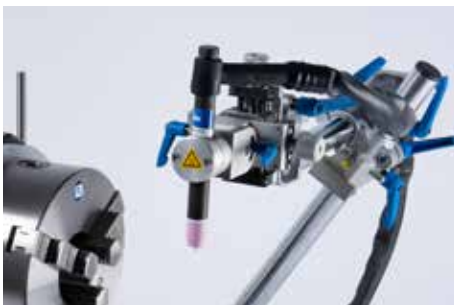
Brennerhalter mit Gelenken auf Kreuzschlitten zur Feineinstellung
