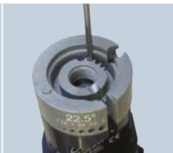
Elektroden spitze anplanen
