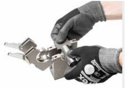
Eine an die Spannkassette befestigte und dadurch unverlierbare Rohrmittenlehre stellt die exakte Positionierung des zu verschweißenden Rohrstoßes sicher.
