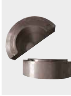
Kammereinsätze für Form-teile zum Schweißen von Formstücken
