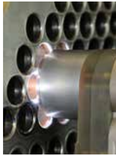
Hochwertige Ergebnisse an horizontalen oder vertikalen Rohrböden
