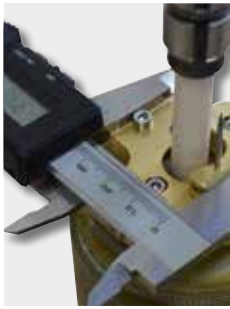
Einfache und präzise Einstellung der Elektrodenposition
