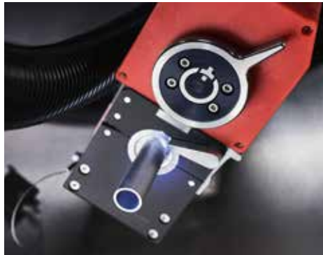
Orbitalschweißkopf OW 17 GC mit Spannkassette
