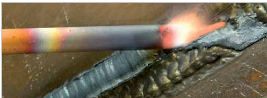
Die KempGouge ARC 800 macht Fugenhobelarbeiten zu einer leichten Aufgabe.
