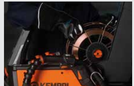
Die Formgebung des von oben zu beladenden Drahtvorschubs sorgt für Ergonomie und Sicherheit beim Wechseln schwerer Drahtspulen
