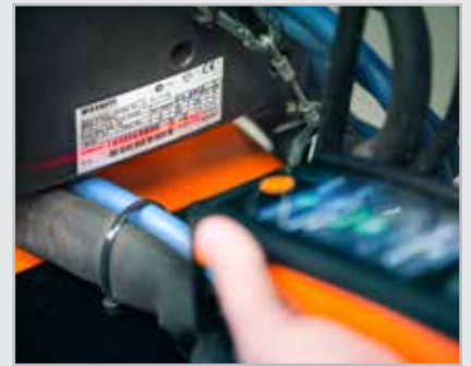
Der ArcValidator RC zeichnet alle individuellen Daten des Validierungsverfahrens für eine spätere Übertragung auf die PC-Anwendung auf.
