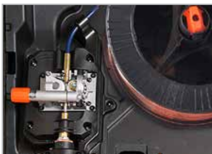
Die Kempact 251-Modelle verfügen über den GT02C-Drahtvorschub mit zwei Rollen.
