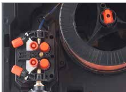
Die Kempact 253/323-Modelle verfügen über den DuraTorque-Drahtvorschub mit vier Rollen.
