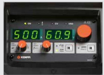
Übersichtliches Bedienpanel mit Auswahl für Lichtbogendynamik und Hot Start Werte.
