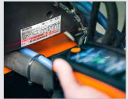
ArcValidator RC registra tutti i dati individuali della procedura di calibrazione per il successivo trasferimento al software per PC.
