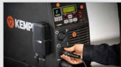
*Il modulo DCM (Digital Connectivity Module) è compatibile in modalità nativa con FastMig di Kempki (ad esempio X5 FastMig) e con le nuove famiglie di prodotti MasterTig, nonché con qualsiasi altro modello o marchio di saldatrice grazie agli adattatori WeldEye. X8 MIG Welder supporta la connettività nativa con WeldEye e di conseguenza non è necessario alcun altro dispositivo.*
