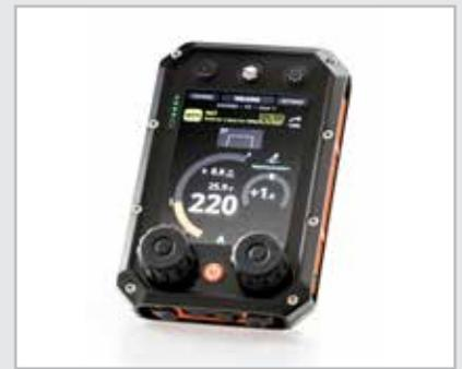
Utilizzando Control Pad, l'interfaccia utente wireless di X8 MIG Welder, per selezionare la WPS digitale (dWPS) tramite WeldEye, il generatore viene configurato automaticamente in base ai limiti presentati nella WPS.
