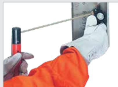
Le unità di comando a distanza wireless R11-T possono essere utilizzate semplicemente mediante contatto dell'elettrodo.
