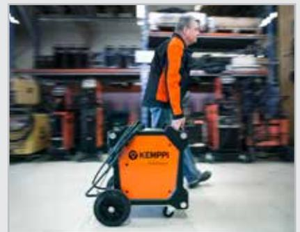
Il banco di carico di ArcValidator è facile da spostare ed è una soluzione universale per la calibrazione dei parchi saldatrici multi-marca.
