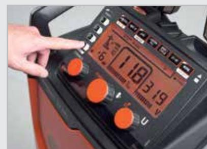
*I modelli Kempact Adaptive (A) offrono funzioni particolari, tra cui l'impostazione dell'alimentazione mediante il controllo dello spessore della lamiera, la selezione dei materiali di apporto e i canali di memoria.*
