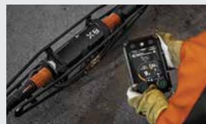
Il display grande e luminoso di X8 Control Pad facilita la regolazione dei parametri.
