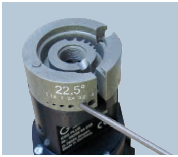
Elektroden anschleifen: 4 unterschiedliche Winkel, 6 unterschiedliche Elektrodendurchmesser
