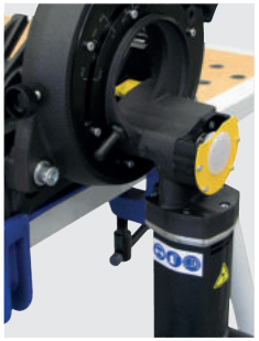
Inklusive zweite Sägeblattaufnahme zum Heraustrennen von Rohrbögen
