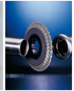
Rechtwinklige und gratfreie Bearbeitung – ideal für Pressfitting-Anwendungen
