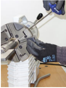
Werkzeug-Schnellspannsystem QTC® (Quick-Tool-Change)
