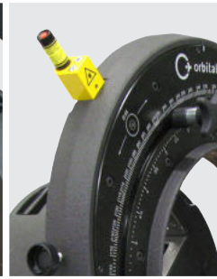
Integrierter Strichlaser zur Trennstellen-Markierung auf dem Rohr
