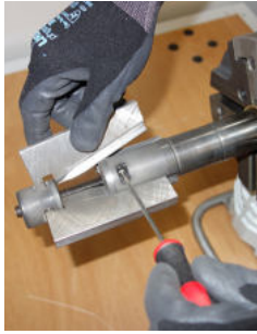
Schnelle Einstellung der Rohrdimension
