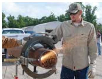
Mechanisiertes Schneiden mit tragbaren Geräten
